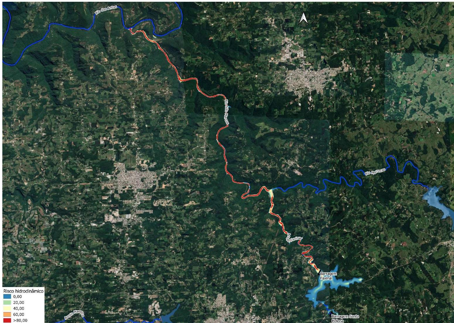
**Figura 6.7-7 - Ruptura por Galgamento – TR = 10.000 anos – Risco Hidrodinâmico**
