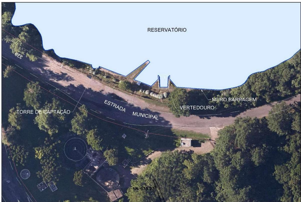
**Figura 5.2-1 – Arranjo Geral da Barragem**
