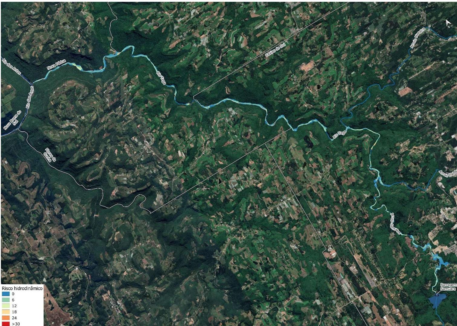
**Figura 6.7-1 - Ruptura por “Pipping” – Risco Hidrodinâmico**
