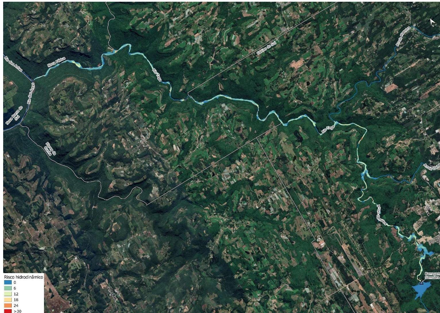
**Figura 6.7-5 - Ruptura por Galgamento – TR = 1.000 anos – Risco Hidrodinâmico**
