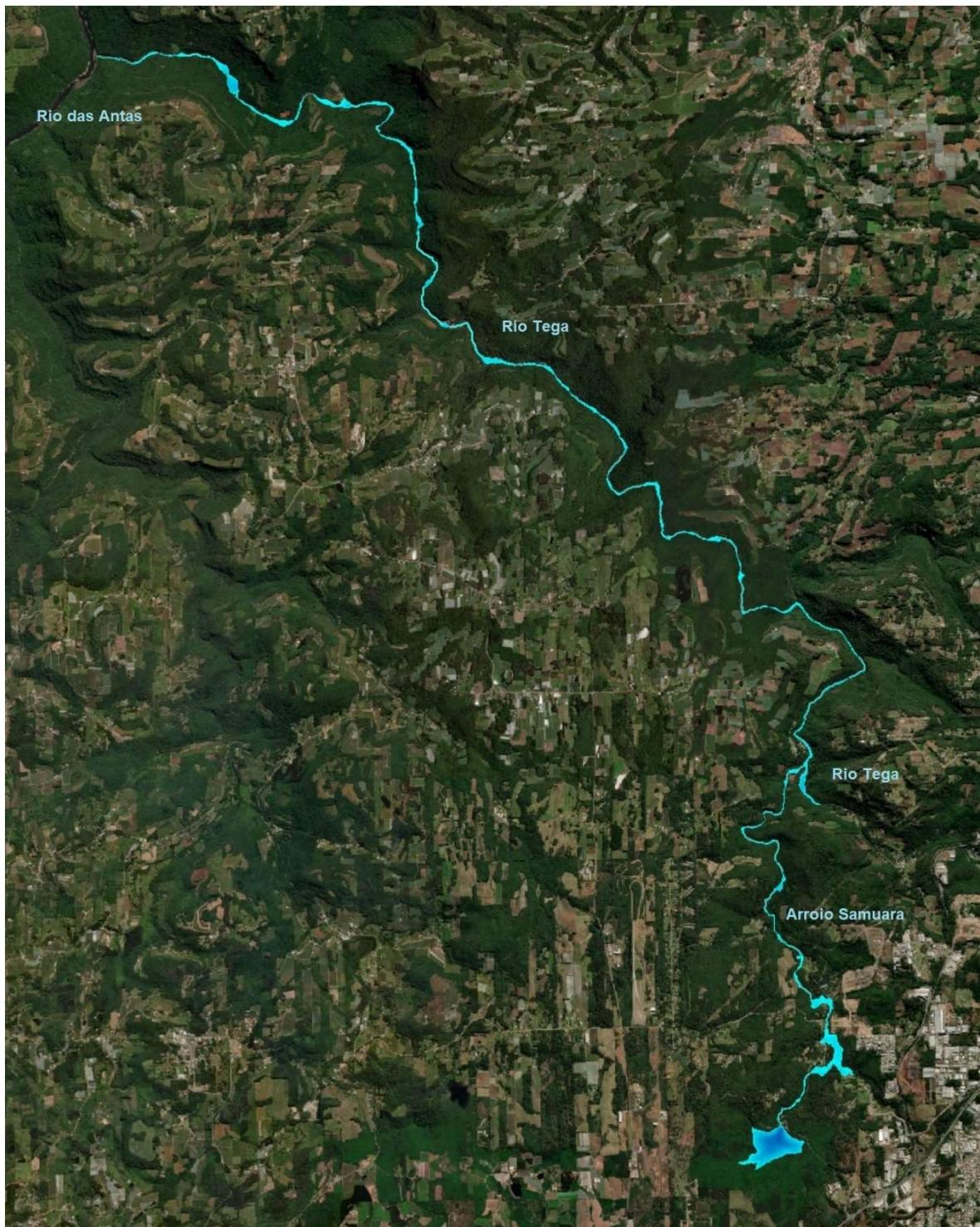
**Figura 6.4-2 – Mancha de inundação pela cheia com 1.000 anos de recorrência, sem ruptura da barragem.**
