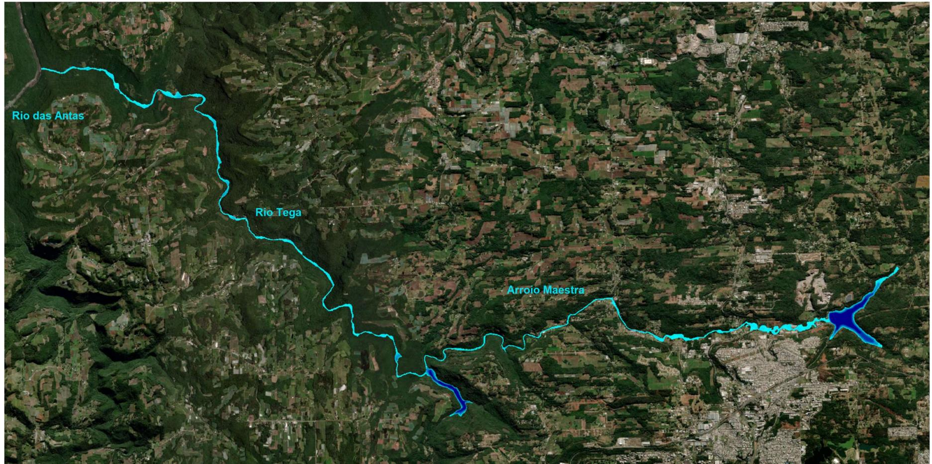
**Figura 6.4-1 – Mancha de inundação pela cheia com 100 anos de recorrência, sem ruptura da barragem.**
