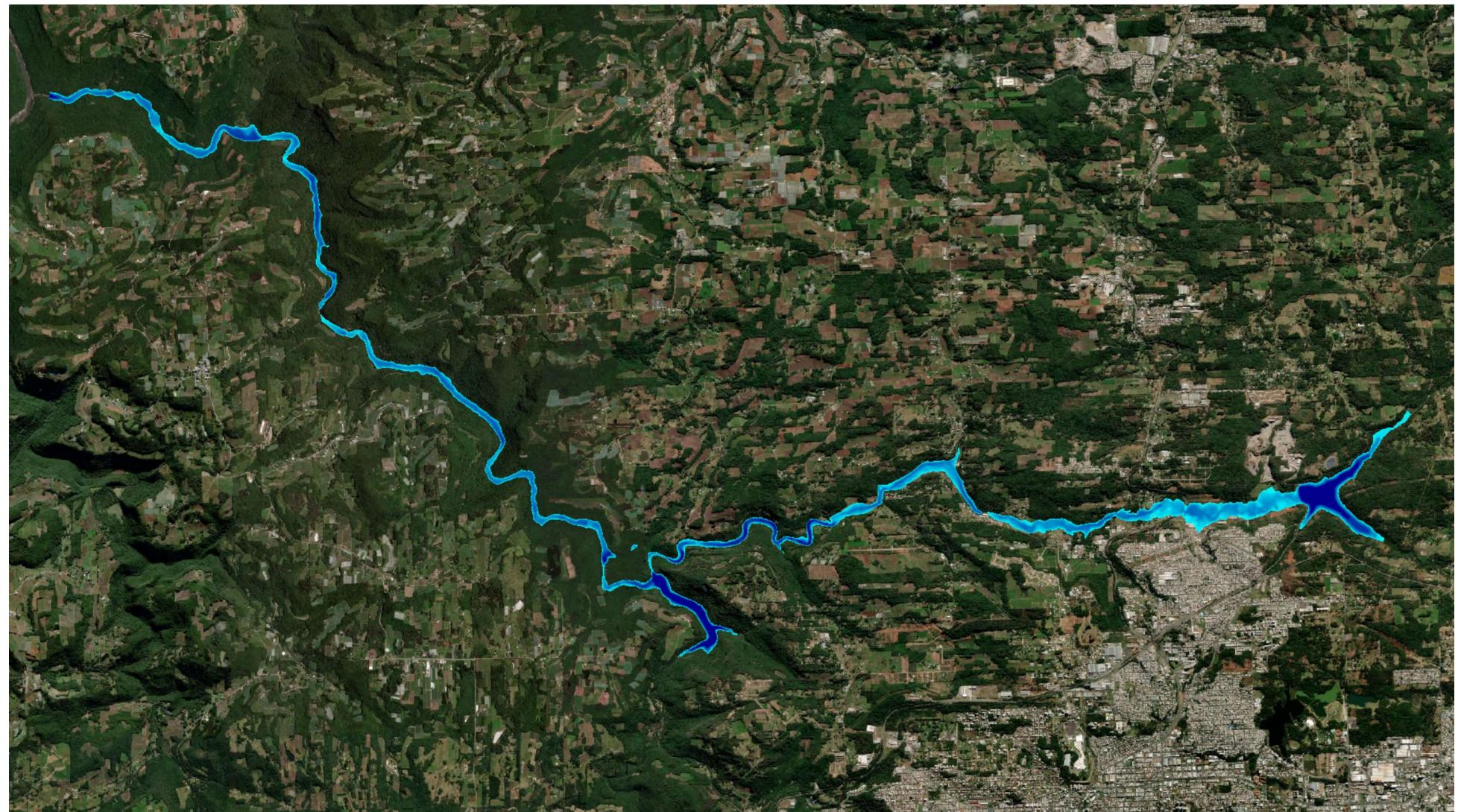
**Figura 6.6-6 – Onda de Ruptura por Galgamento da Barragem – TR = 1.000 anos - Planta da Mancha de Inundação Máxima.**
