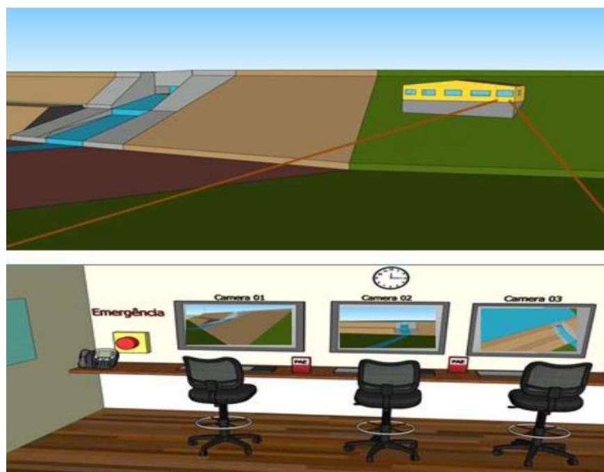
**Figura 16.1-1 - Ilustração de um Sistema Típico de Monitoramento, Comunicação e Alerta**
