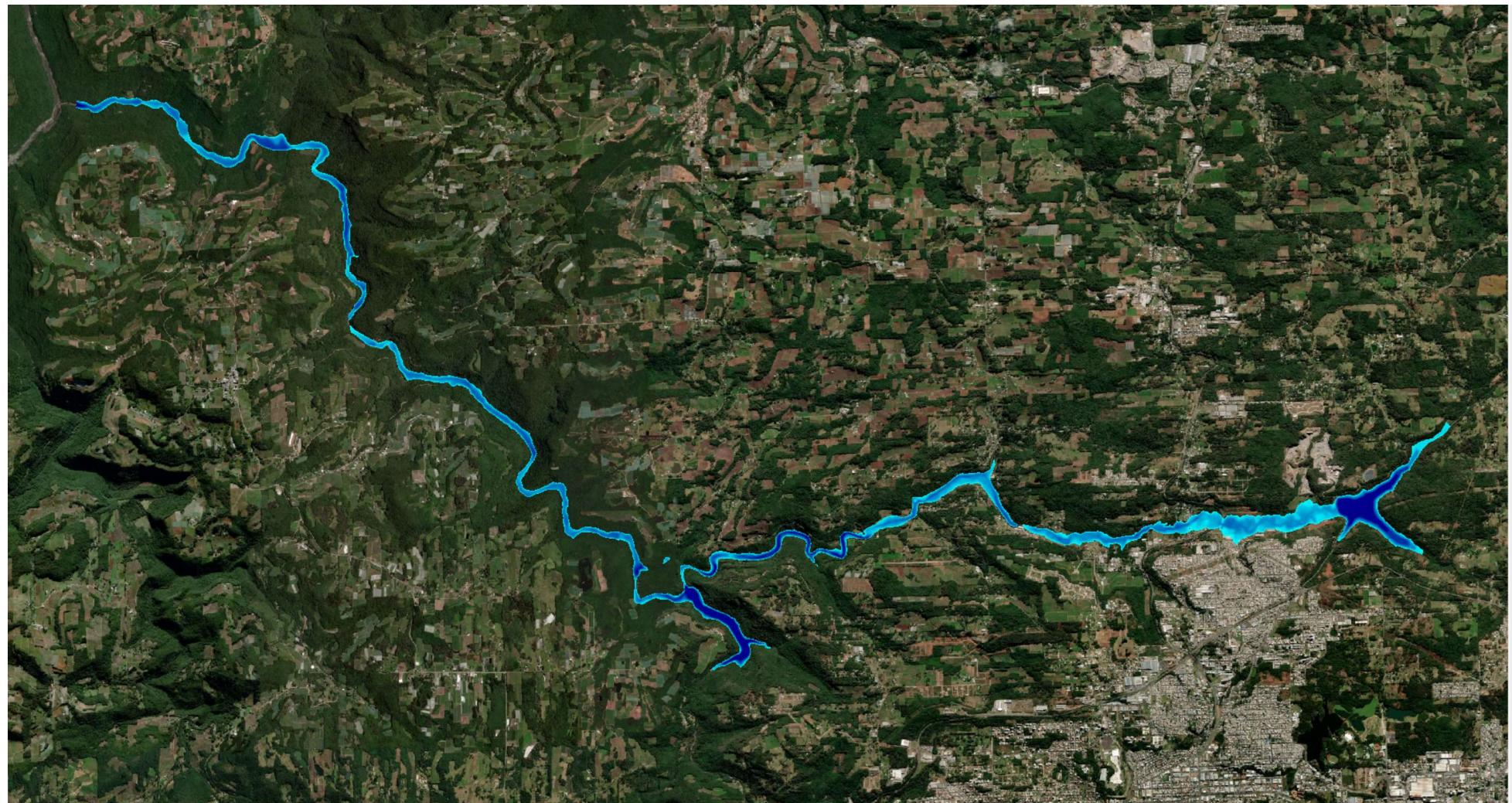
**Figura 6.8-8 – Onda de Ruptura por Galgamento da Barragem – TR = 10.000 anos - Planta da Mancha de Inundação Máxima.**
