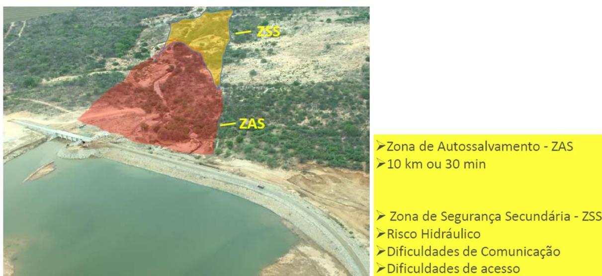
**Figura 15-1 - Ilustração da ZAS e ZSS de uma Barragem Genérica**
