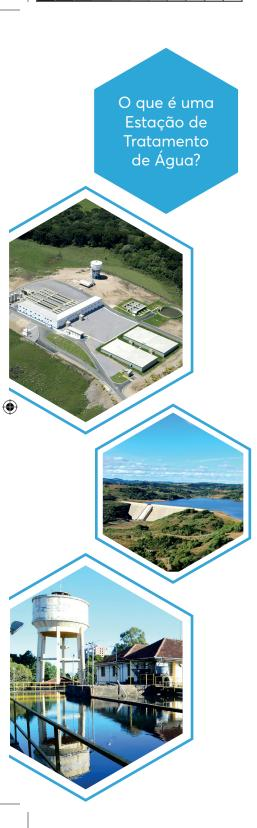
Na Estação de Tratamento de Água (ETA) é realizado o processo de purificação da água bruta. Inicialmente, a água captada das represas chega à estação com características indesejáveis ao consumo. Durante o tratamento, a água passa por seis diferentes processos sucessivos, são eles; coagulação, floculação, decantação, filtração, desinfecção e fluoretação.
